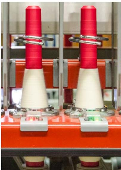
Dois LEDs diferentes para identificação do fuso
