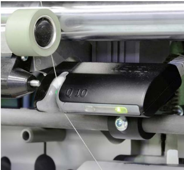
O R 37 pode ser equipado opcionalmente com o Q 10, a nova geração de limpadores de fio da Rieter. As principais vantagens do limpador do fio com sistema digital comprovado em fição e medição óptica são:
