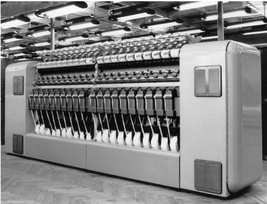
Şekil 1: Çekim sistemlerinin yerine açıcı silindirlerin kullanıldığı, dünyanın ilk open end iplik makinası modeli (M 40-V open end iplik makinası modeli).
