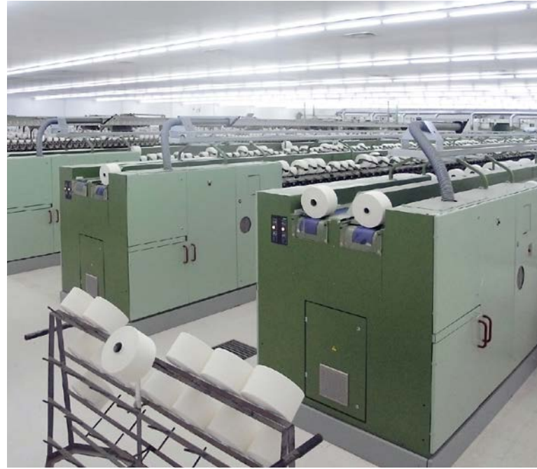
Şekil 7: Tayland'daki bir iplik işletmesinde bulunan BT 923 makinası, 2005 yılında "sihirli" limit olan dakikada 100 000 rotor devrini ilk defa aşmıştır.
