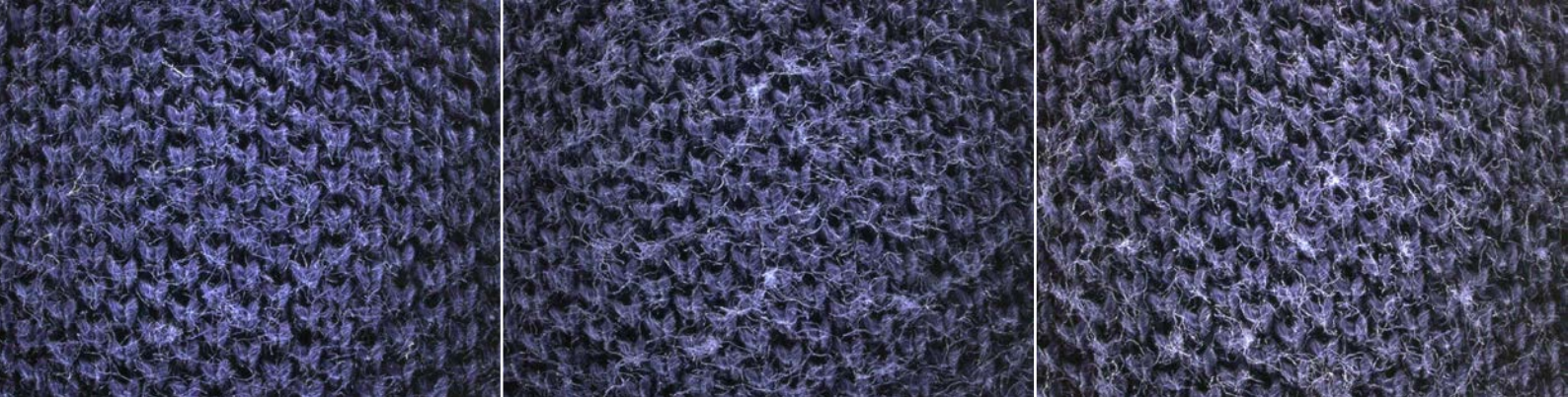
Şekil 1: Boncuklanma testi, Com4®jet iplik ile üretilmiş "Rieter" polo tişörtün önemli avantajlar sağladığını göstermektedir.
