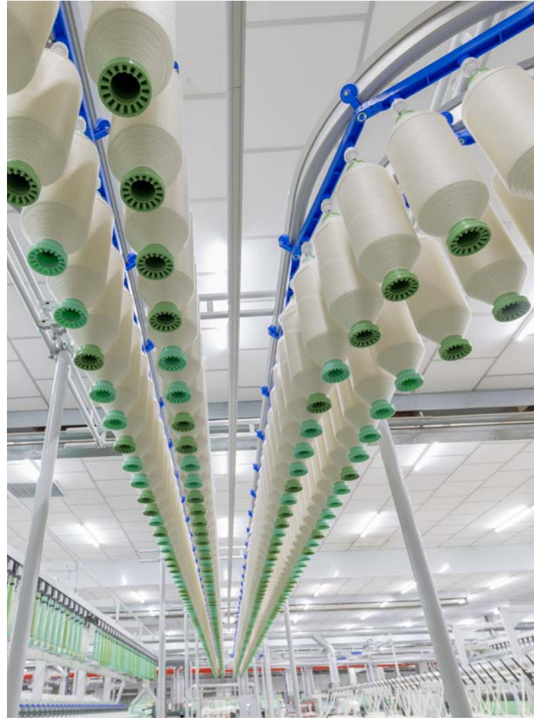
Şekil 6: Fitil bobini taşıma sistemi SERVOTrail, alan kazanılmasını ve fitil bobinlerinin geçici olarak daha güvenli bir şekilde depolanmasını sağlar
