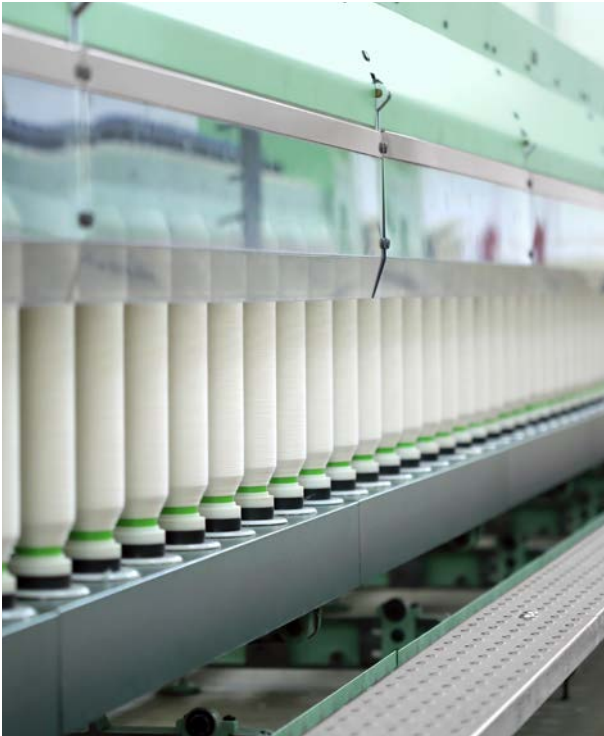
Şekil 2: 224 iğli uzun bir fitil makinası üç ila dört ring iplik makinasını besler.
