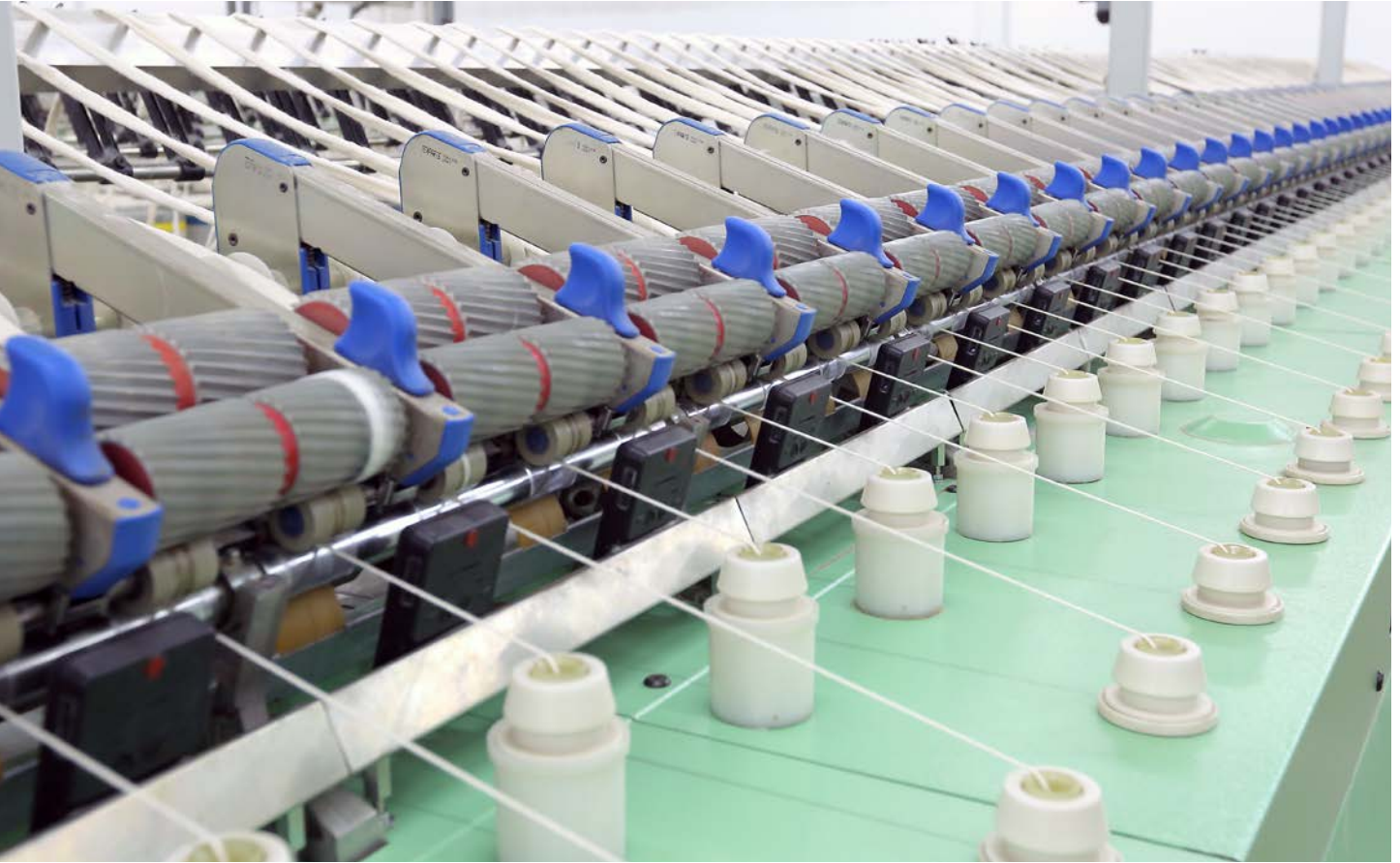
Şekil 4: Entegre istatiksels analizlerle gerçekleştirilen fitil gerginlik ayarı ve ayrı ayrı fitil izleme, sabit kaliteyi garanti eder.
