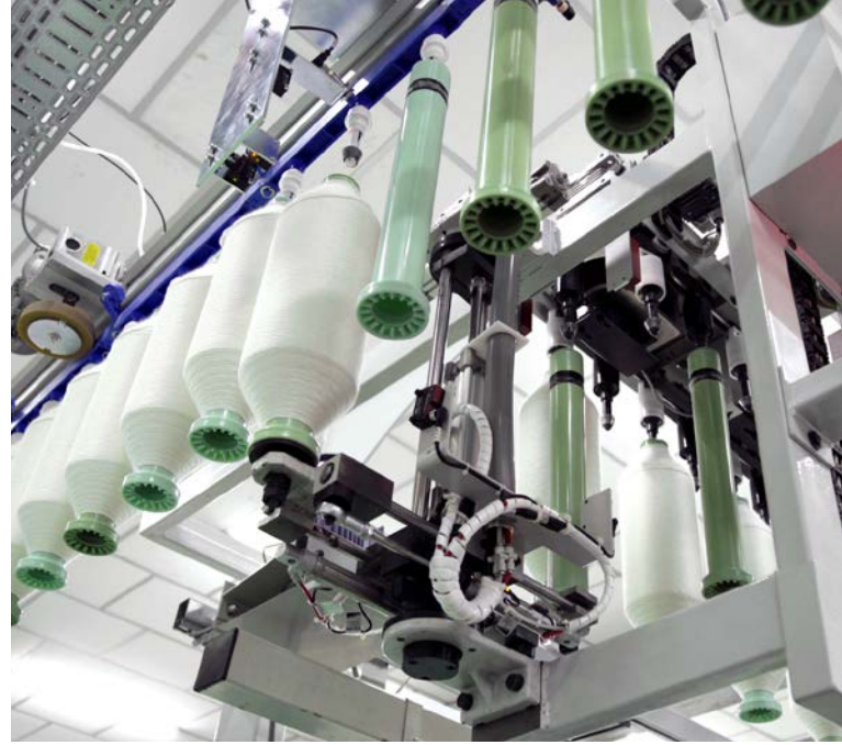
Şekil 3: Bobin değıştirici, makinanın baş ya da uç kısmına monte edilebilir. Bu, taşıma sistemine entegrasyonu kolaylaştırır.
