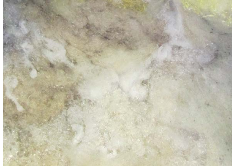
Şekil 2: Şerit beslemesi (üstte) ve eğirme sırasında atılan pislik parçacıkları (altta) iyi elyafın tamamen kullanıldığını göstermektedir. S 36 eğirme kutusundaki optimum hava akışı ve gelişmiş elyaf kılavuzu bunun temelini oluşturur.
