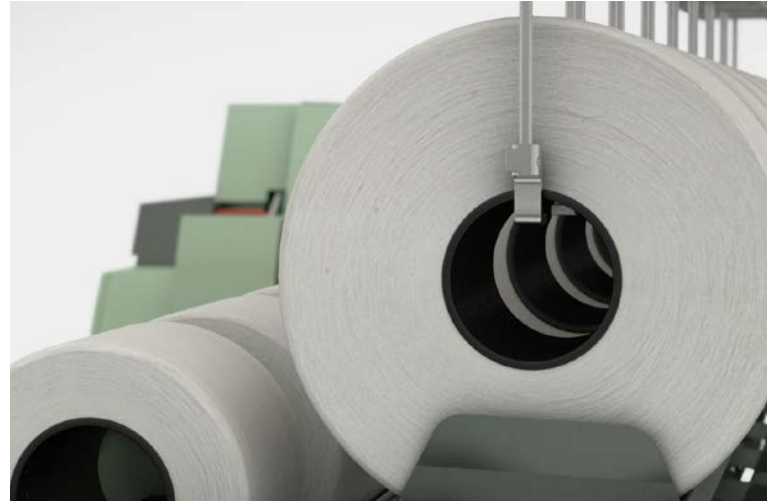
Şek. 3: Vatka aktarım işlemi sürecinde tülbente temas edilmediği için kalite garanti edilir.
