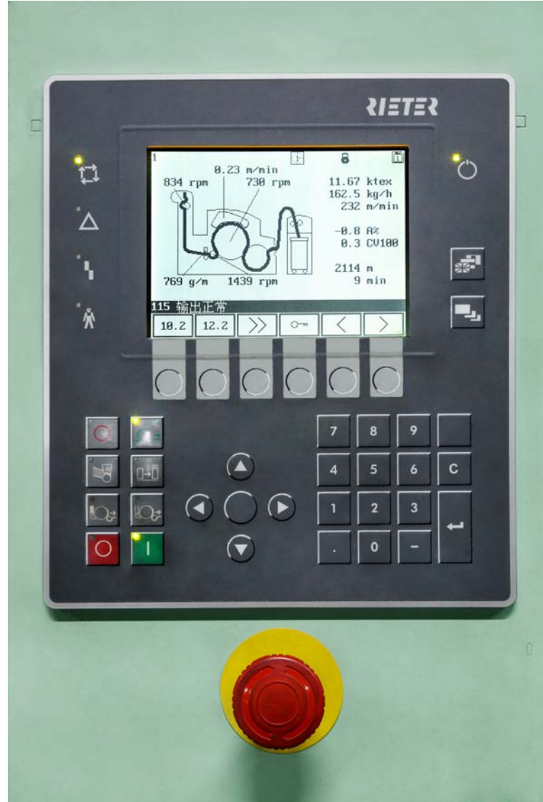
Şek. 2: Üretimi %100 artırıyor: C 70 tarak makinası, 160 kg/sa hızda çalışır.
