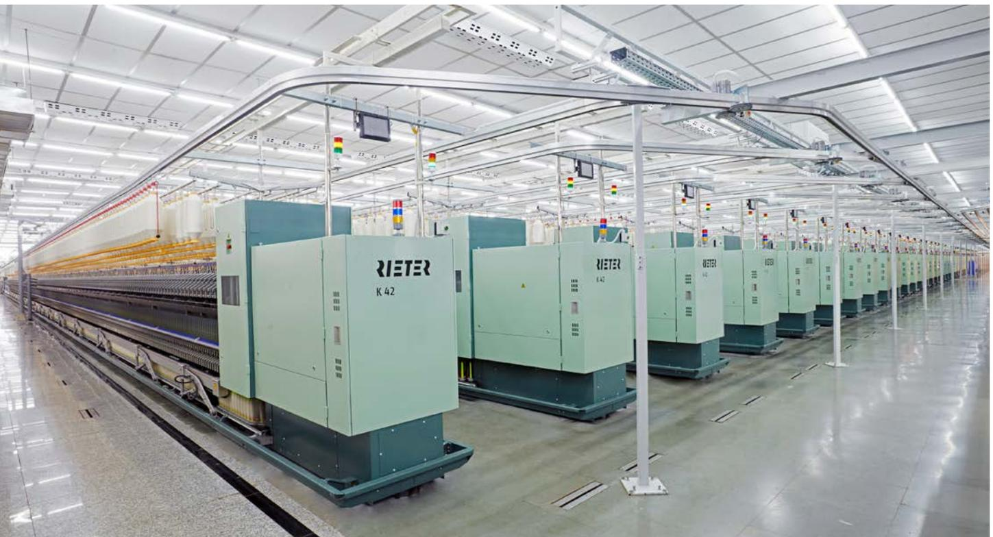
Abb. 1: Hohe Garnqualität dank der Kompaktspinnmaschine K 42
