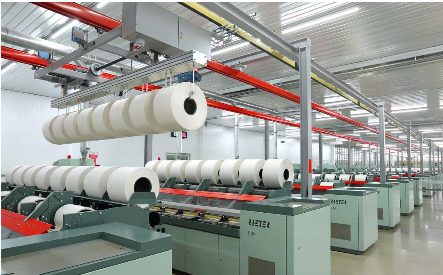
**Abb. 1:** Der E 26 transportiert effizient und platzsparend die Wickel vom OMEGAlap E 36 zu den Kämmaschinen.
