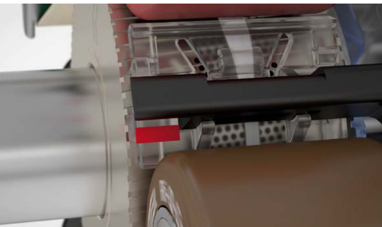
Abb. 4: Das Luftleitelement Detect der Kompaktspinnmaschinen ermöglicht gleichbleibend hohe Garnqualität.
