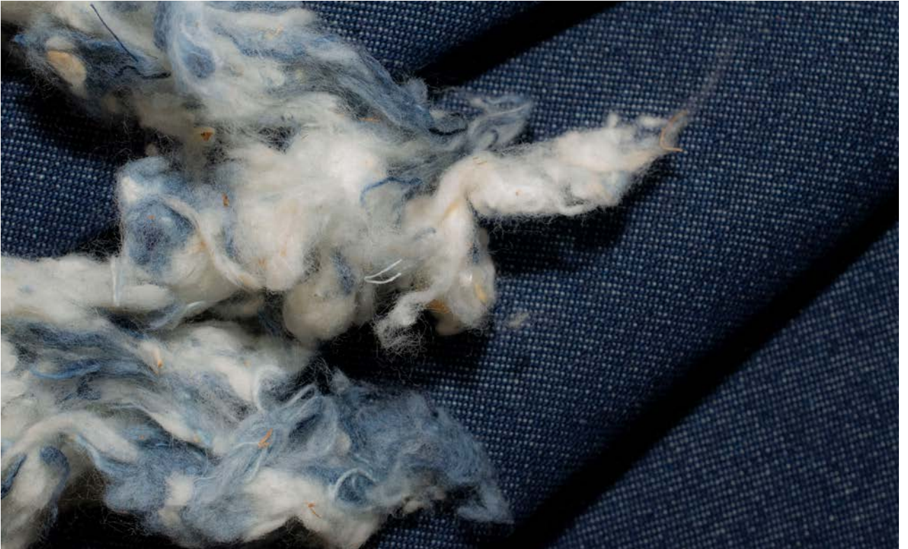
Şek. 1: %70 ham pamuk ve %30 tüketici sonrası materyalden üretilen denim kumaşta kusursuz kalite sağlanmıştır.
