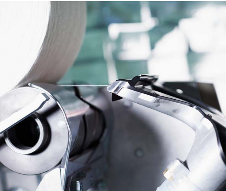
Şek. 1: Optimize edilmiş emiş kolu borusu, üst iplik arama sırasında güvenilir iplik alımı sağlar.
