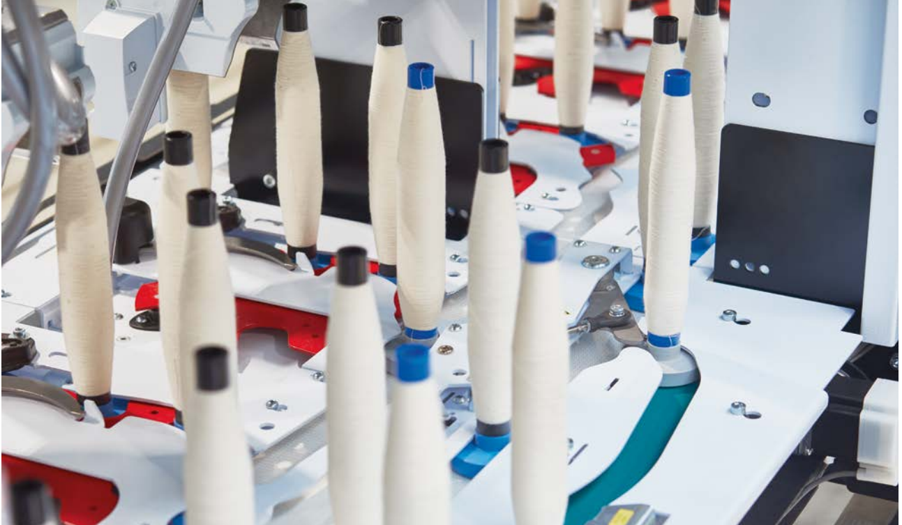
Şek. 4: Multilot'lu Multilink sistemleri, dört adede kadar farklı materyal beslemesini işleyebilir.
