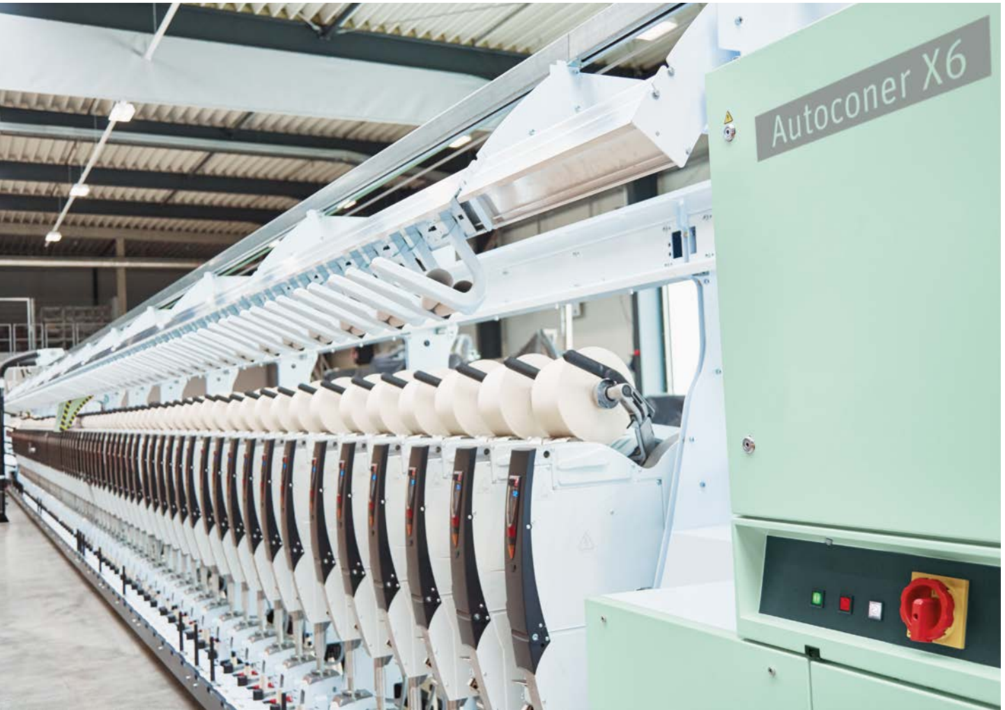
Şek. 1: Autoconer X6, ring ve kompakt iplikçilik prosesinde nihai kalite güvence adımıdır.
