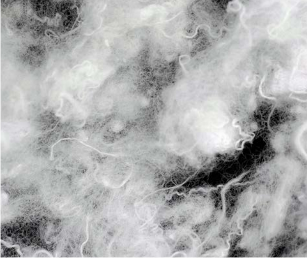
Şek. 2: Tarak makinası beslemesinde zorlu materyal karışımı
