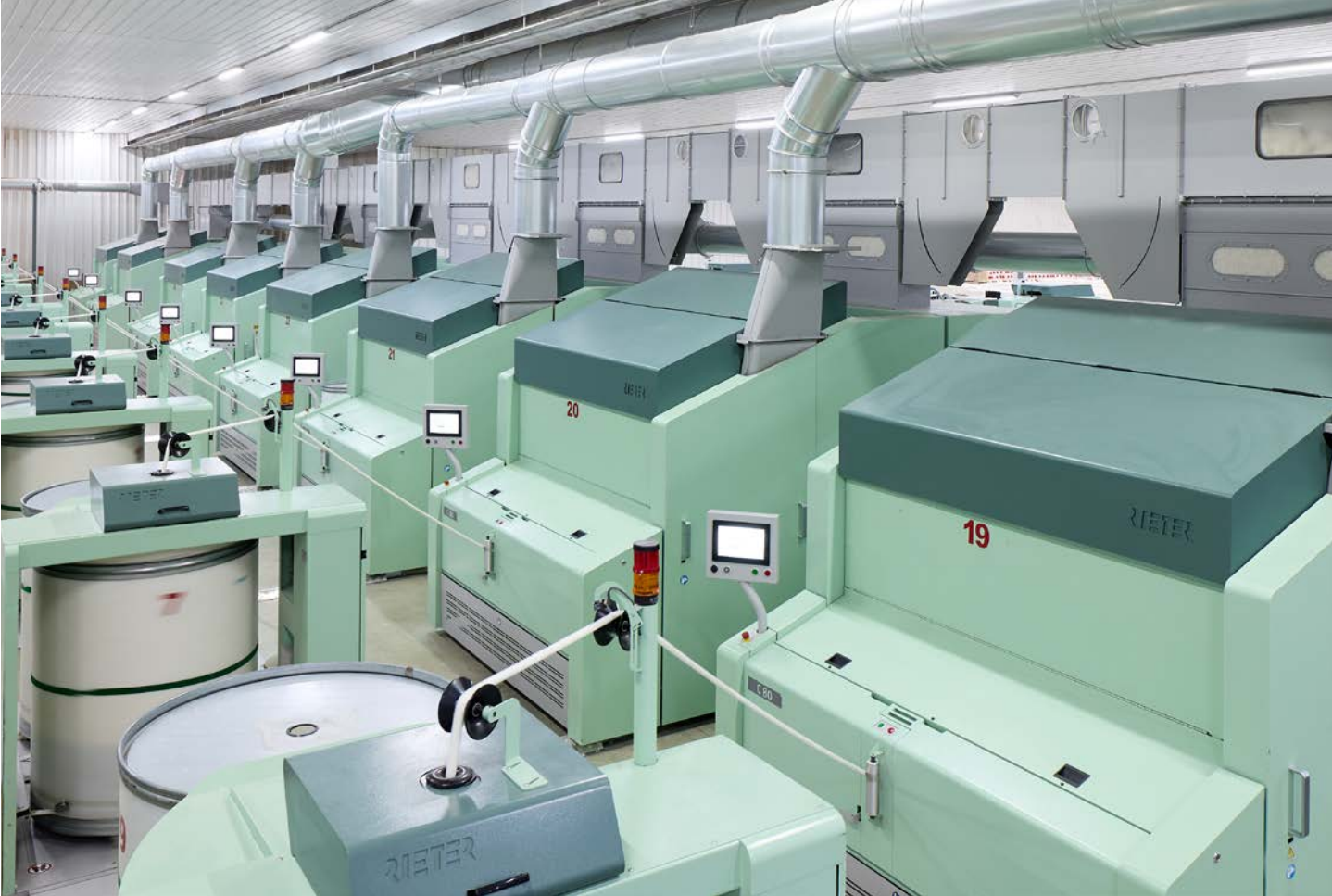
Şek. 4: Yüksek kaliteli tarak şeridiyle üstün performans gösteren tarak makinası C 80
